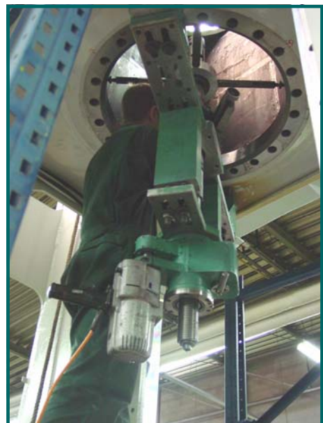
Bohren und Plandrehen der Hydraulikzylinderaufnahme Boring and facing of the hydraulic cylinder housing
